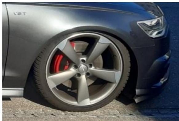
Manipuliertes Luftfahrwerk ohne Federwirkung
